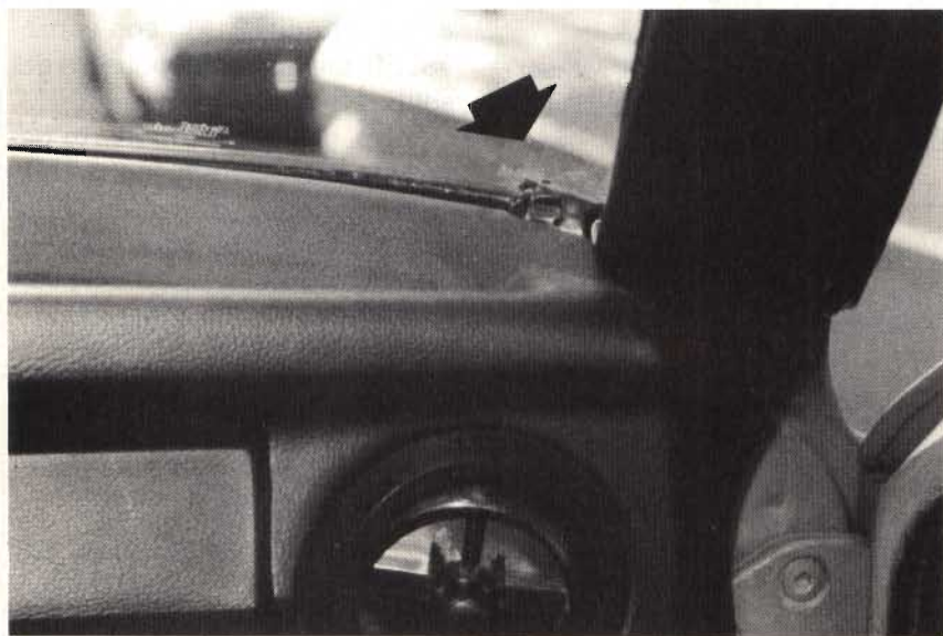
Posizionamento del sensore visto dall'interno.
